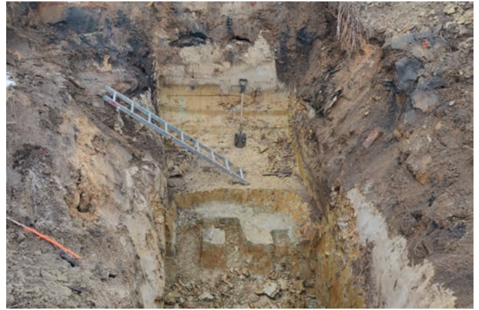
Rys. 7. Pobór blokowych próbek gruntu z dna wykopu badawczego [3]
