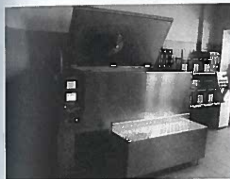
Rys. 9. Laboratorium zakładowe – komora do badania mrozoodporności betonu
