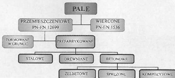
Rysunek 4. Uproszczona klasyfikacja pali
